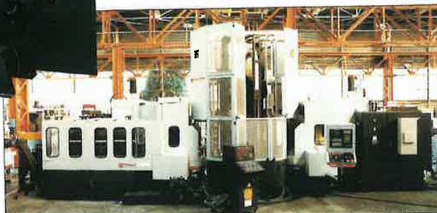
2 centres d'usinage horizontaux FH45 équipés d'un magasin de palettes vertical.
